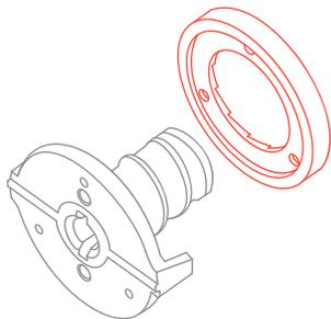
7. 回転バリはオーガーに取り付けられています。回転バリを取り外すには、まずバリを固定している3本のネジをプラスドライバーで外します。ネジの中に挽いたコーヒーが入っていて、ネジの取り外しに支障がある場合は、小さなブラシで挽いたコーヒーを取り除いてからネジを取り外してください。**図 G と H**
