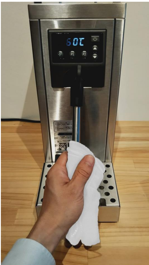
⑤湿らせた 清潔なタオル等で、 ノズルの先端を拭きあげます。
