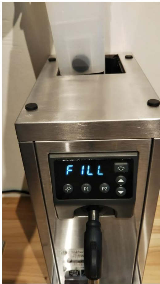
⑤湿らせた 清潔なタオル等で、 ノズルの先端を拭きあげます。
